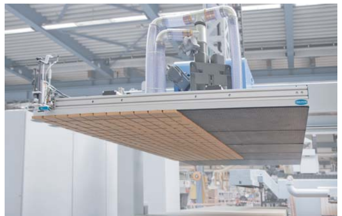
在嵌套加工中用施迈茨整层搬运式吸具系统 SPZ-NG 对多层工件进行整层拆垛
