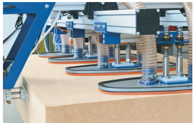
建筑材料 | 蜘蛛手式真空端拾器 SSP 搬运和分离多孔绝缘片
