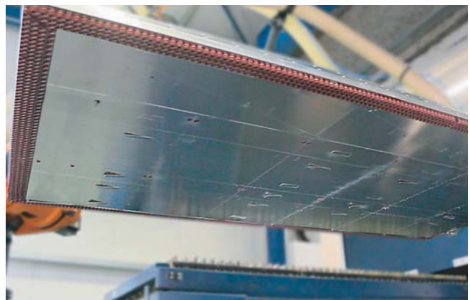
在坯料板的激光加工过程中用整层搬运式真空夹具系统 SPZ 进行卸料
