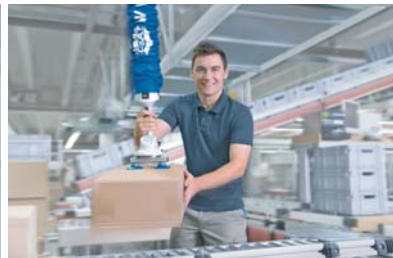
真空搬运系统
