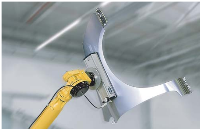
焊装车间使用大面真空吸具系统 FXP 搬运车身部件
