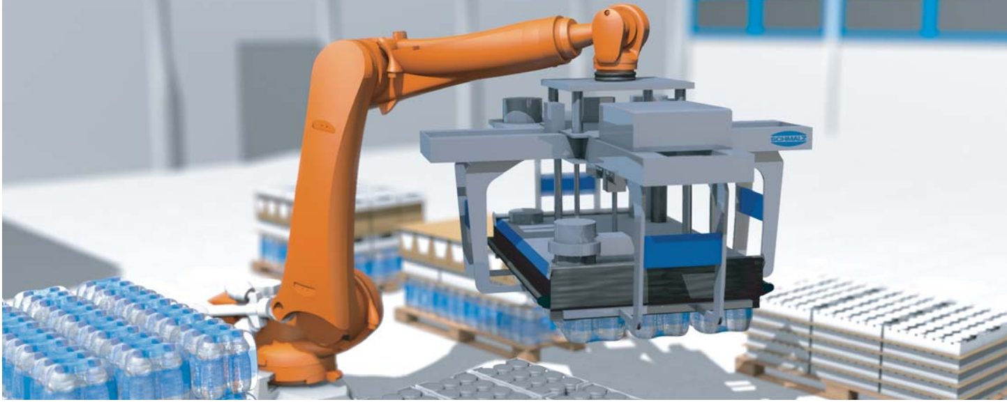
整层搬运式真空吸具系统 SPZ-M-C 广泛应用于货物的码垛和拆垛
