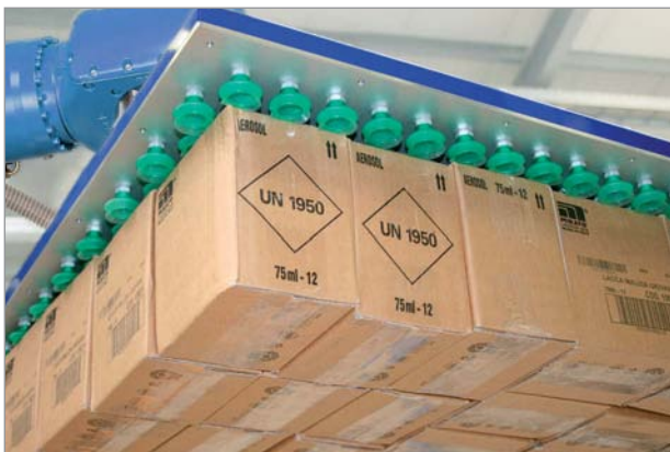
超耐磨和灵活Elastomer制成的吸盘SPB1-ED
