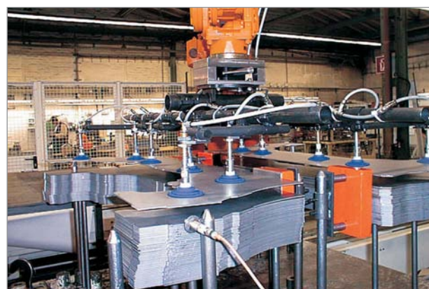
弹簧缓冲支杆FSTE-HD安装实例
