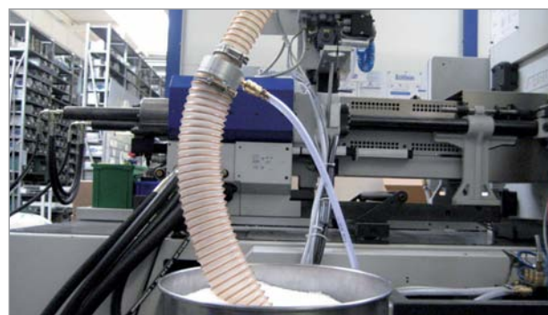
输送型真空发生器SEC应用于输送塑料颗粒物
