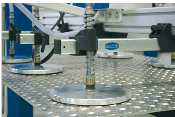
吸盘SPK用于搬运粗糙或表面高低不平的工件
