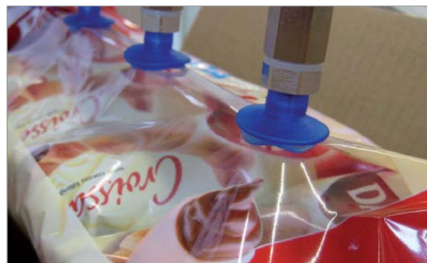
波纹吸盘FGA-PVC应用于抓取软袋包装
