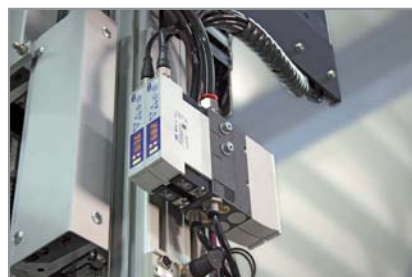
集成式真空发生器SMPi在衬垫轴上
