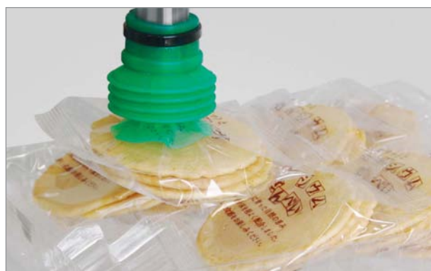
波纹吸盘SPB4用于搬运薄膜包装的米饼
