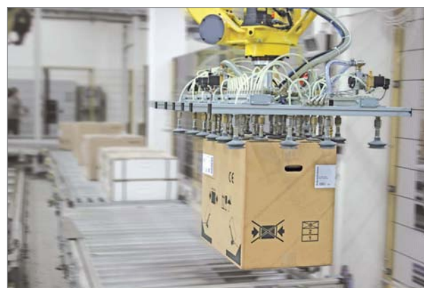
天然橡胶制作的柔软FSGA-NK吸盘用于搬运纸箱
