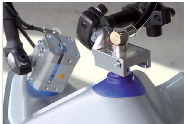
杯型吸盘SAXM适合搬运成形后钣金件
