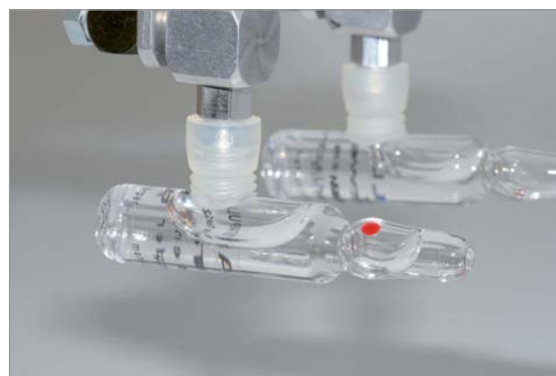
硅橡胶制成的波纹吸盘FSG应用于搬运医用安瓿
