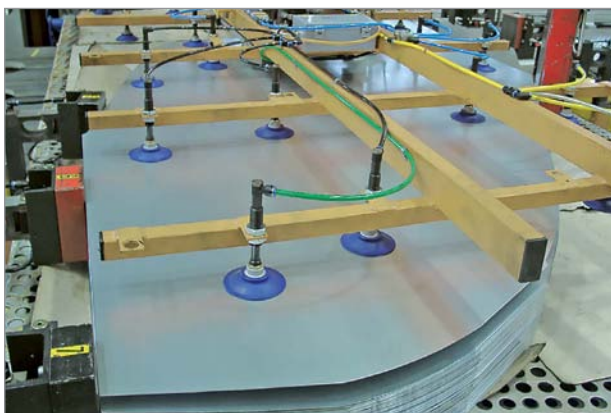
装有弹簧缓冲支杆FSTI的真空横梁
