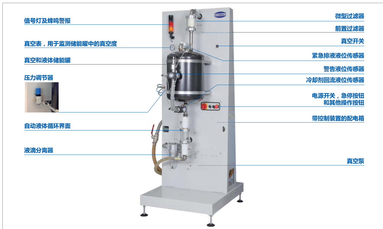
自动排水真空中心站VOC结构设计
