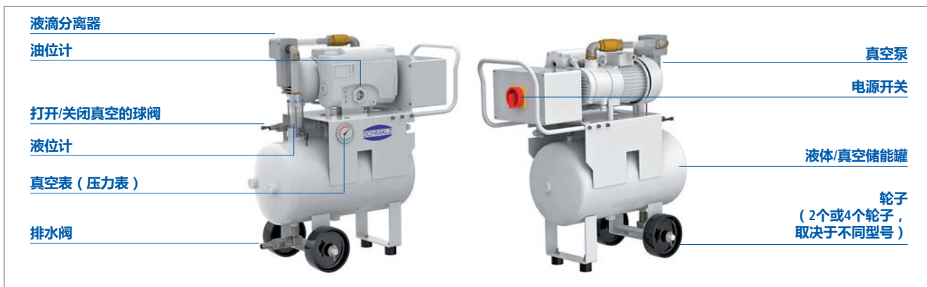
真空发生单元VAGG结构设计
