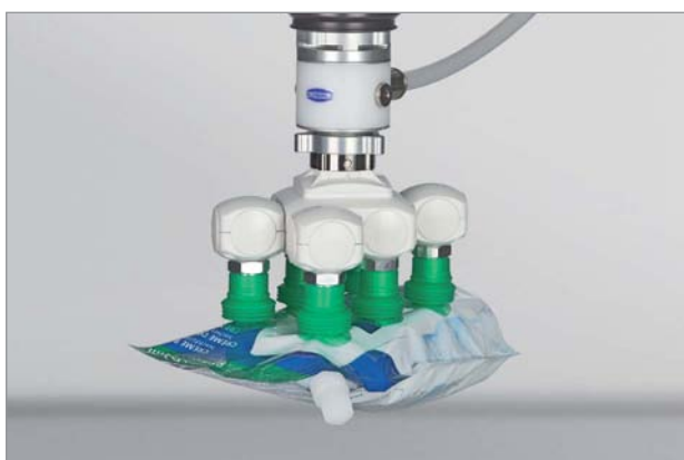
带真空端接器系统的吸盘SPB4用于搬运装满液体的立式小布袋
